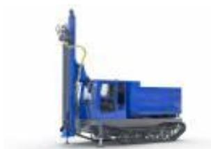
Электрическая самоходная буровая установка BVR-185-30 E с погружным пневмоударником. Станок полностью электрифицирован, что позволяет работать в карьерах с ЛЭП. Установка оснащена мощным электрическим компрессором KB 20/25, что позволяет бурить скважины диаметром до 200 мм и глубиной до 30 м.
