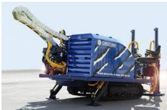
Установка на гусеничной базе. Максимальная длина бурения – 150 м. Максимальный диаметр расширения – 400 мм. Максимальный крутящий момент – 4000 Н\*м. Данная установка ГНБ поставляется без кабины, но комплектация может быть дополнена по желанию заказчика.
