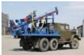
Установка предназначена для бурения геофизических и структурно-поисковых скважин, разведки месторождений твердых полезных ископаемых, строительных материалов и подземных вод, инженерно-геологических изысканий, устройства водозаборных и других скважин. Бурение производится вращательным способом с промывкой или продувкой скважины или шnekами.
