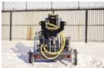
Буровой навес с двигателем мощностью 80 л.с. Глубина бурения с промывкой – 200 метров. Максимальный начальный диаметр долота – 300 мм. Максимальный крутящий момент – 1500 Н\*м. **Комплектацию уточняйте у менеджера.**
