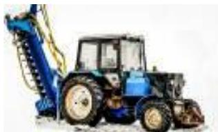
Установка с бурильно-крановым оборудованием. Транспортная база для установки – трактор.
