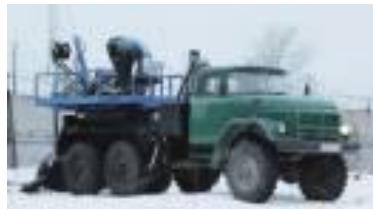
Бурильно-крановая машина с поворотно-выдвижной платформой позволяет с одной постановки машины в рабочее положение пробурить сразу несколько скважин. Продольное смещение платформы дает возможность с максимальной точностью расположить машину над точкой бурения.
