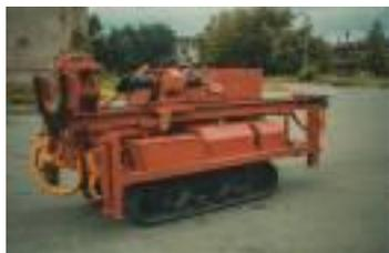
Малогабаритная буровая установка с дизельным двигателем мощностью 60 л.с. на самоходной гусеничной базе. Глубина бурения с промывкой – 250 метров. Максимальный начальный диаметр долота – 300 мм. Максимальный крутящий момент – 2000 Н\*м.
